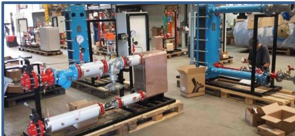
**Sur demande en chaufferie d'essai TIGR - Contrôle des performances par tests dynamiques.**
